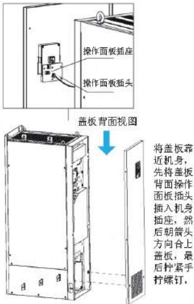
图 3-19 1~K 尺寸机型盖板安装示意图
